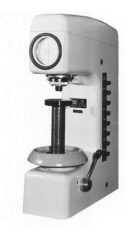
Figure 1.8 Hardness testing machine. (Werkstoffprüfmaschinen, Leipzig)
